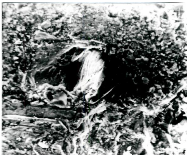
Рисунок 2.10 – Появление новых зёрен из матрицы связки. Условия шлифования: АИШ; V = 25 м/сек ; P_n = 1,2 МПа ; f = 66 кГц; круг 12A2-45°AC6-100/80 M1-01-4; обрабатываемый материал Т15К6
