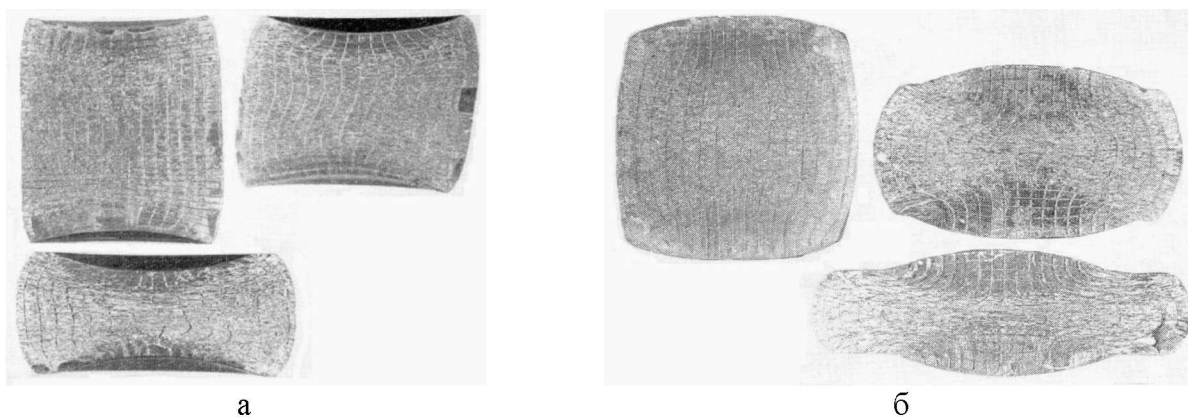
Рис. 1 – Образцы с координатной сеткой, осаженные а – выпуклыми и б – вогнутыми сферическими плитами [1]
