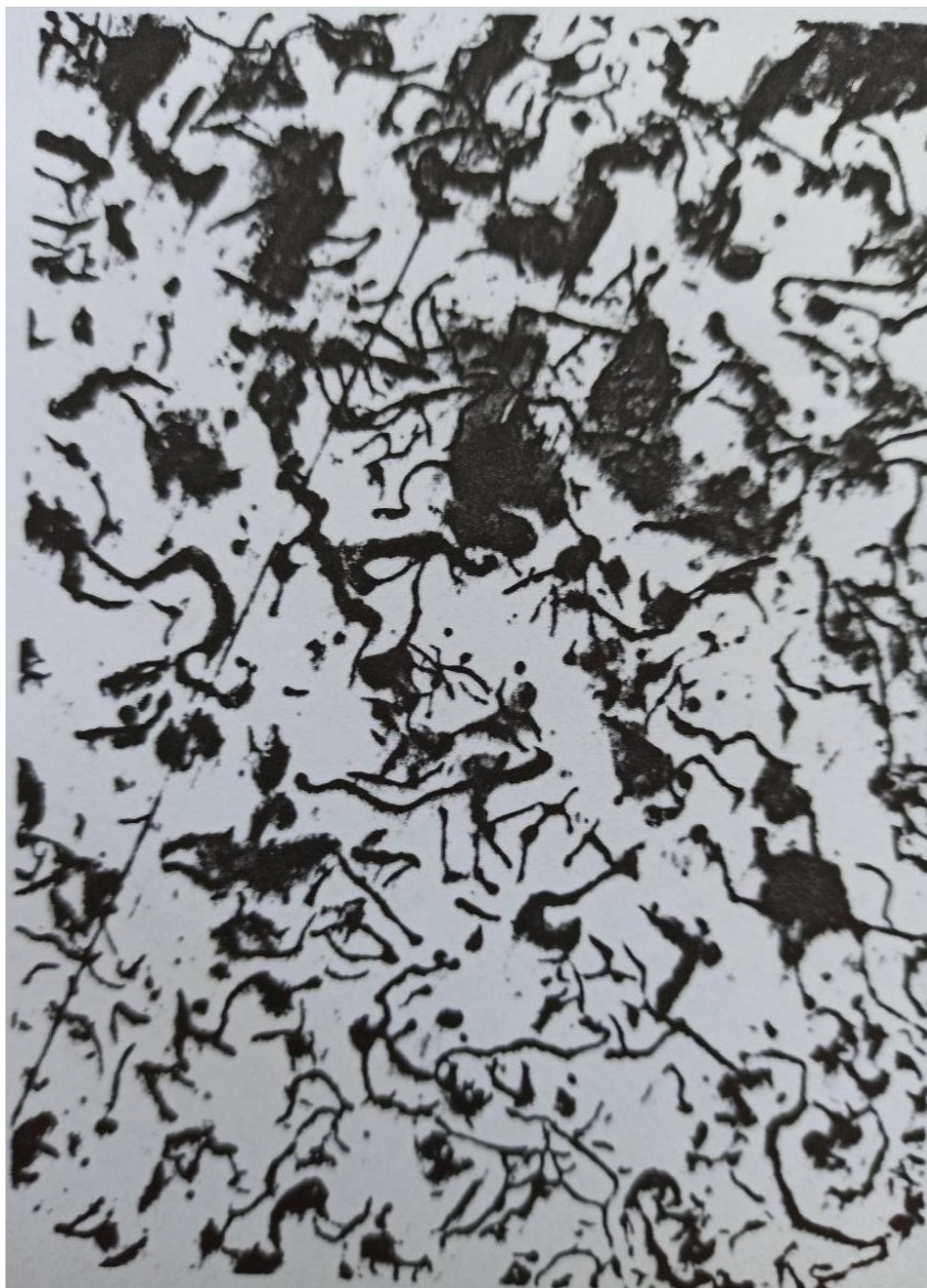
Рисунок 5.20 - Мікроструктура зразку №3 (основа), \times 300
