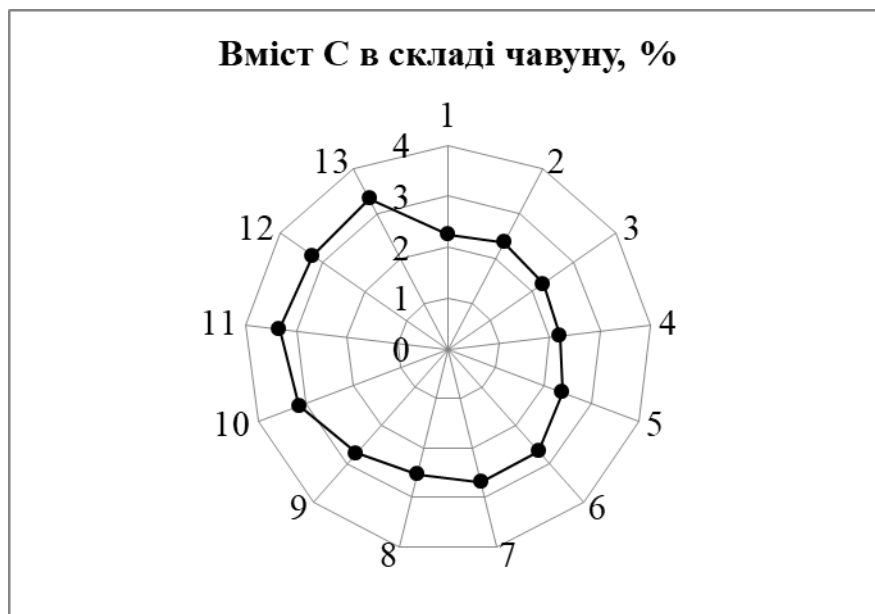
Рисунок 3.1 - Розподіл вмісту вуглецю в зносостійкому чавуні
