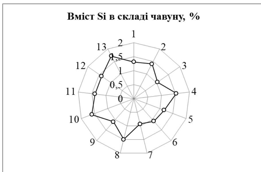
Рисунок 3.2 - Розподіл вмісту кремнію в зносостійкому чавуні
