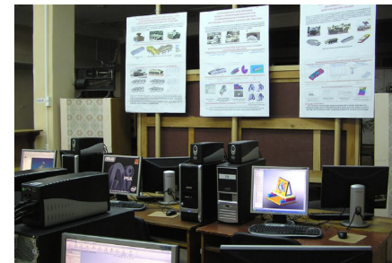
Рис. 9. Центр "Тензор" та комп'ютерний кластер "Політехнік-125": процесорні ядра – 64; пам'ять – 128 Gb; продуктивність – 0,5 Tflops
