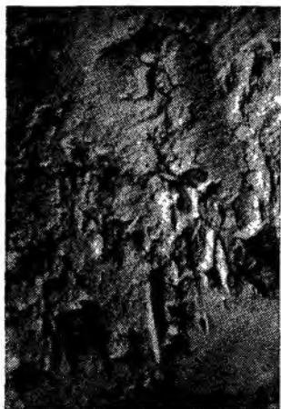
Рис. 26. Участки поверхности синтетического поликристаллического алмаза марки АСБ после шлифования кругом АСВ 100/80 — 100% — МВ1 ( v_{кр} = 25 м/с, S_{пр} = 1 м/мин, p = 0,1 МПа), \times 5000 .
