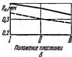
Рис. 69. Влияние положения пластинки относительно круга (а) на шероховатость режущей кромки (б) при обработке различных сплавов кругом АСО 50/40 — 100% — Б1 ( v_{кр} = 30 м/с, S_{пр} = 1,0 м/мин, S_{п} = 0,01 мм/дв. ход, \beta = 70^\circ , без охлаждения):
