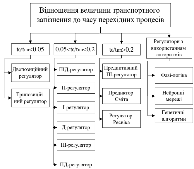
Рисунок 2 – Вибір регулятора залежно від відношення часу транспортного запізнення до часу перехідних процесів
