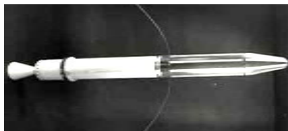
Рис. 5. Внешний вид первого американского ИСЗ «Эксплорер-1» (1958 г.; полная масса – 14 кг; США) [14]
