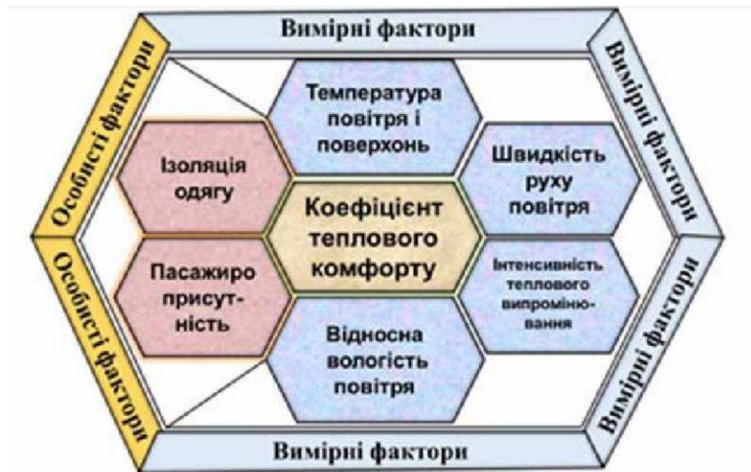
Рисунок 1 – Вимірні і особисті фактори для визначення теплового комфорту в міському транспортному засобі
