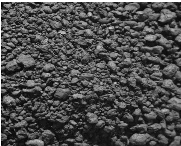
Рисунок 3.1 – Зовнішній вигляд нікель-цинкового фериту(N3Z7) синтезованого за температури 1000 °С при ізотермічній витримці 2 години
