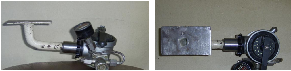
Рисунок 1 – Загальний вигляд пристрою для визначення адгезійної міцності вогнезахисних покриттів
