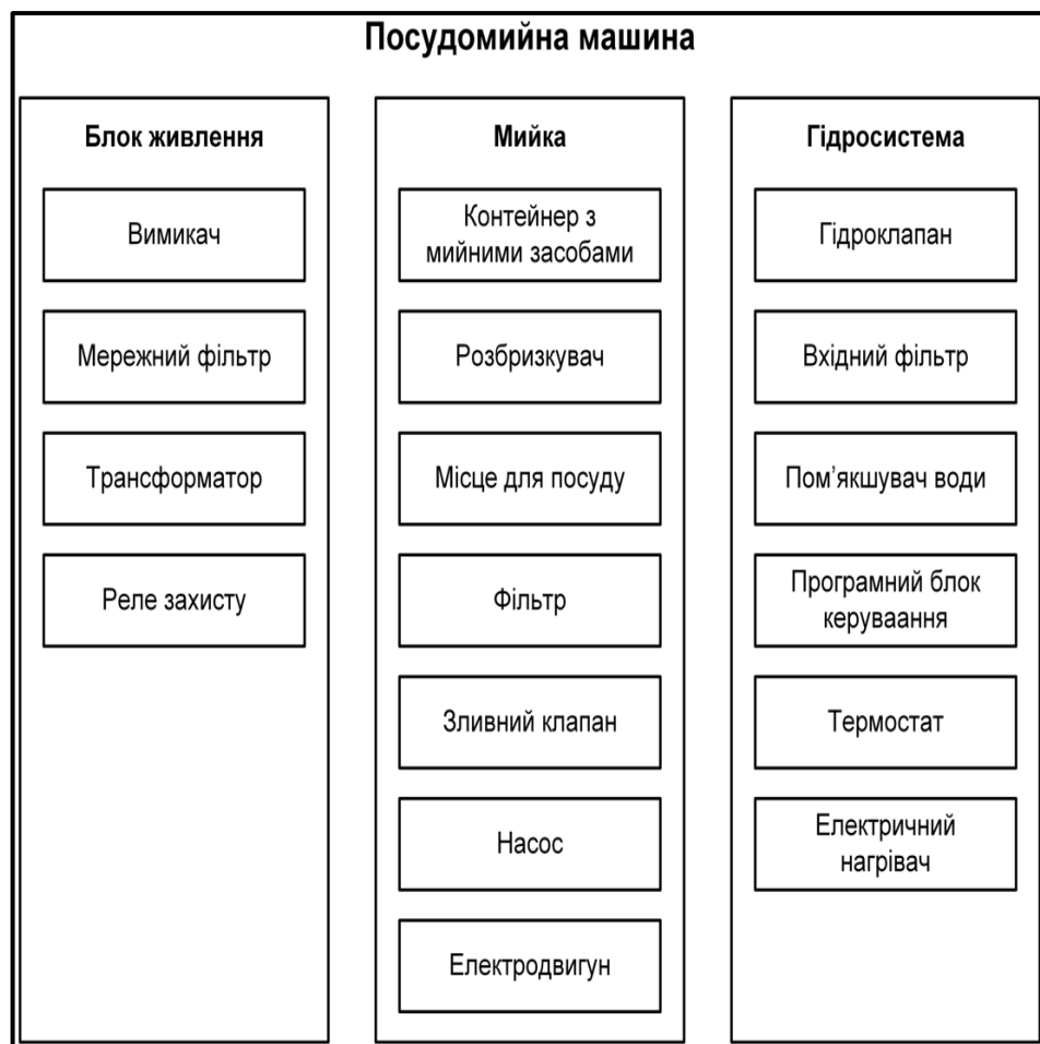
Рисунок 4.3 – Модель «Склад системи» на прикладі системи «Посудомийна машина»
