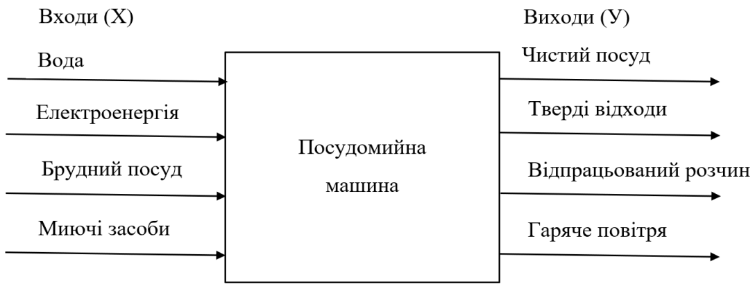
Рисунок 4.2 – Модель «Чорна скринька» на прикладі системи «Посудомийна машина»
