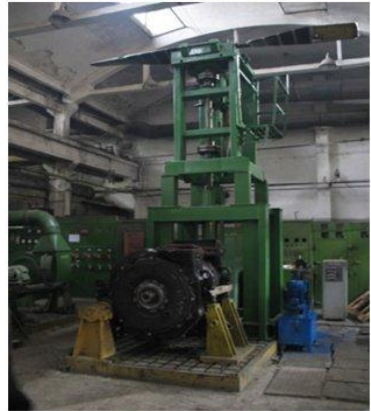
Рис. 4. Стенд динамических испытаний и фото стенда 1-электродвигатель постоянного тока, 2-конический редуктор, 3-цилиндрический редуктор, 4-шпиндель цилиндрического редуктора, 5-лопасть с гибкими элементами, 6-трос, 7-узел подшипников с корпусом, 8-шток, 9-поршень, 10-гидропневмоаккумулятор, 11-гидроцилиндр, 12-гидрораспределитель, 13-узел крепления троса, 14-втулка
