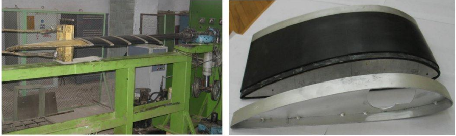
Рисунок 3 – Стенд для статических испытаний и лопасть с гибкими элементами и тросами
