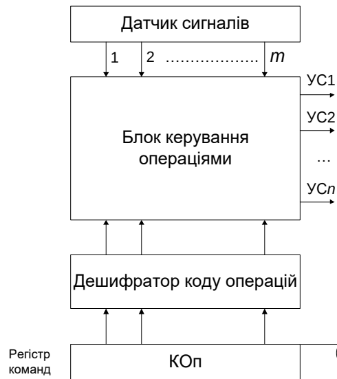
Рис. 10.4. Функціональна схема схемного пристрою керування
