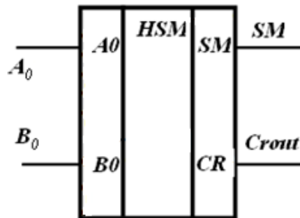
Рис. 4.33. Умовне графічне позначення півсуматора
