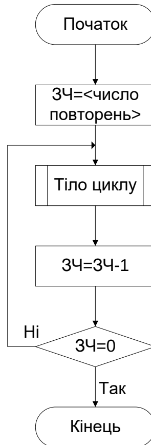
Рис. 12.3. Структура рахункового циклу з пост перевіркою
