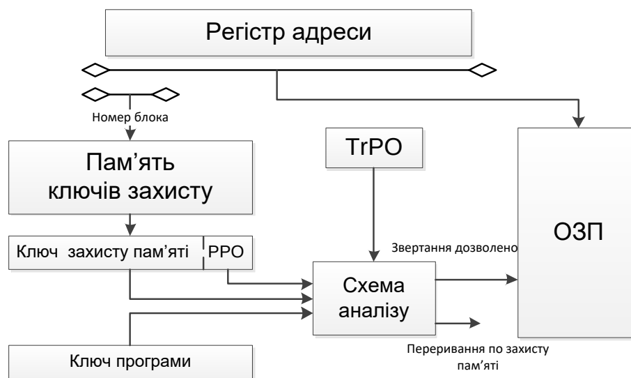
Рис. 11.16. Захист пам'яті методом ключів захисту
