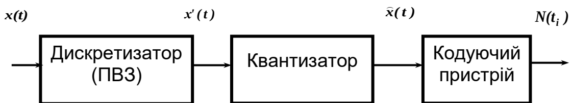
Рис. 7.2. Узагальнена структурна схема АЦП
