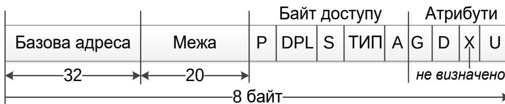
Рис. 13.7. Структура дескриптора сегмента
