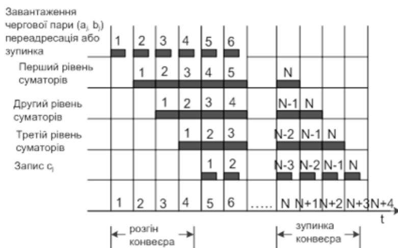
Рис. 14.25. Множення векторів на конвеєрі
