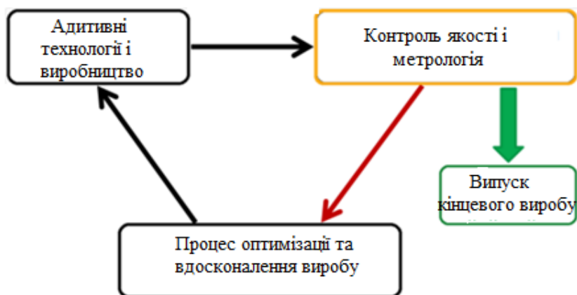
Рисунок 4.10 – Ітеративний процес оптимізації для проектування та виробництва деталей АВ на основі використання даних РКТ
