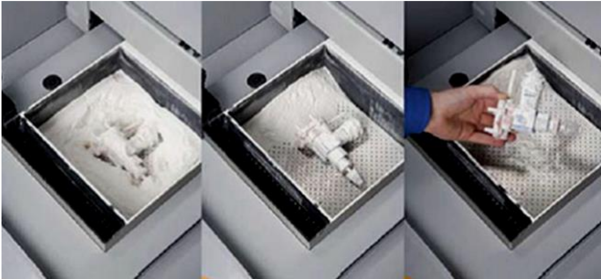
Рисунок 3.3 – Автоматизоване видалення природніх порошкових підтримок з використанням вібраційно-вакуумних пристроїв
