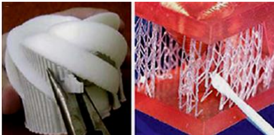
а б Рисунок 3.2 – Механічне видалення матеріалу підтримки: а – FDM-виріб; б – SLA-виріб
