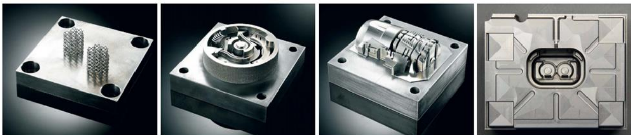
Рисунок 3.14 – Модулі гібридного адитивного формоутворення та отримувані вироби:
