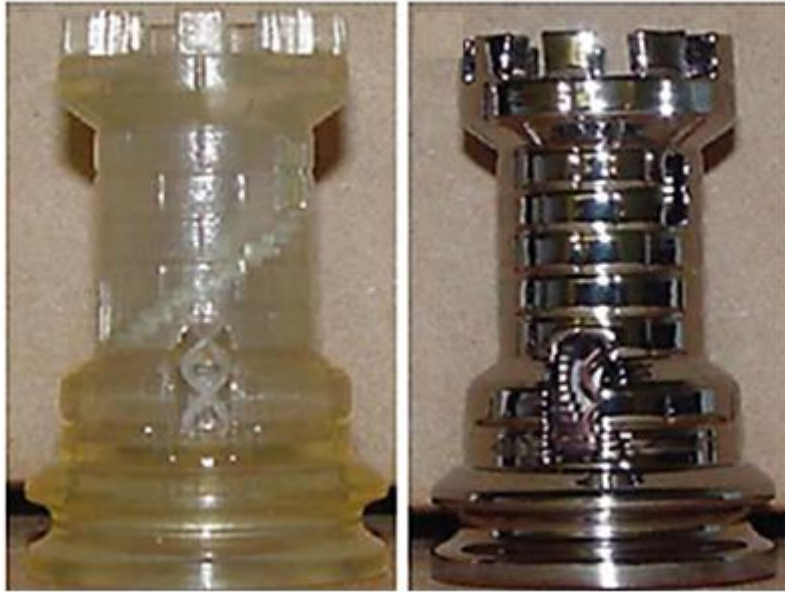
Рисунок 3.16 – Стереолітографічний виріб після SLA (а) та після нанесення декоративно-функціонального покриття хрому (б)
