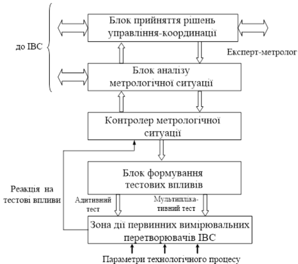
Рисунок 9 – Структурна схема нечіткої моделі управління для задачі контролю якості роботи ІВС
