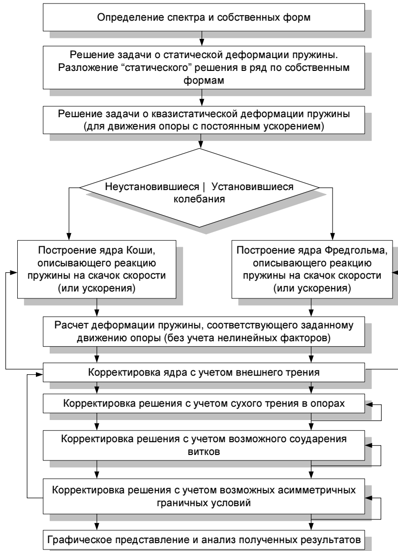
Рис. 3 – Блок-схема численно-аналитического алгоритма решения задачи.
