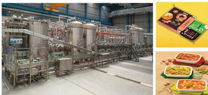
Рис. 1 – Система безперервної мікрохвильової термічної стерилізації на дочірньому підприємстві з переробки харчових продуктів ТАТА (ліворуч) і стабільні страви, вироблені компанією (праворуч)
