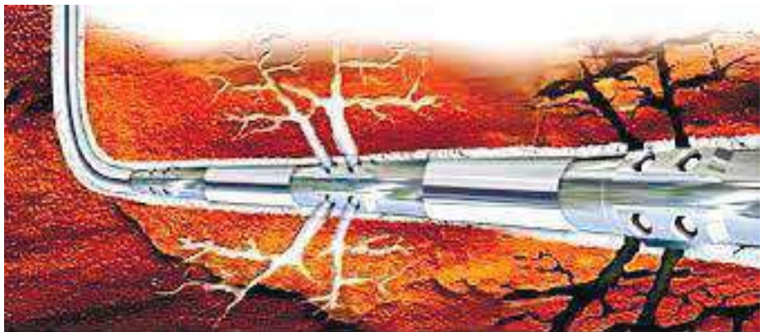
Рисунок 4.19 – Вдосконалена технологія похило-скерованого буріння та поінтервального гідророзриву сланцевого пласта
