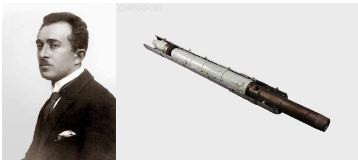
Рис. 4.11 – Винахідник вибійного свердловинного двигуна Матвій Капелюшников і його турбобур (Баку, 1923 р.)
