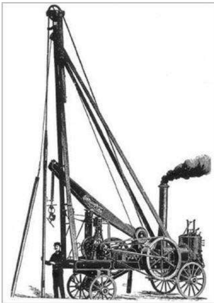
Рисунок 4.6 - Буровий верстат, у якому для приводу «вахача» використано локомотив
