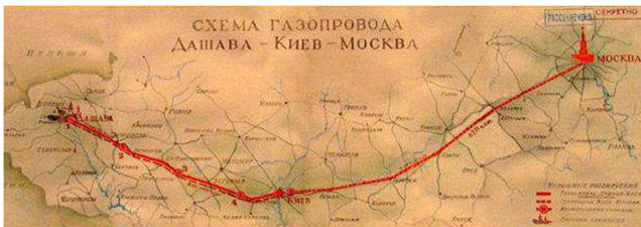
Рисунок 3.56 – Секретна схема газопроводу «Дашава – Київ – Москва»
