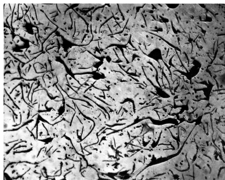
Рис. 1 - Микроструктура чугуна, модифицированного силикобарием, \times 200
