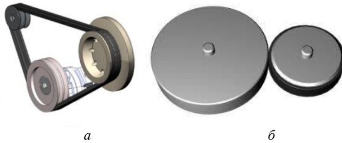
Рис. 3.3. Передачі з використанням сил тертя: а – пасова; б – фрикційна
