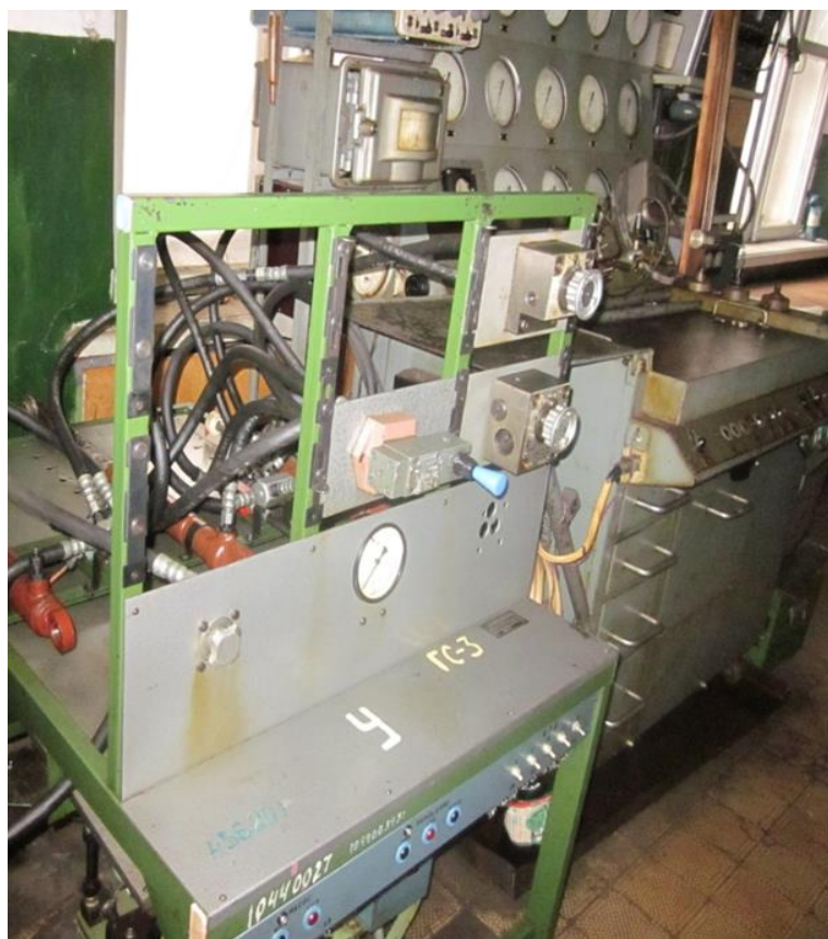
Рисунок 7 – Загальний вигляд лабораторного стану для проведення випробувань елементів і систем гідروприводів
