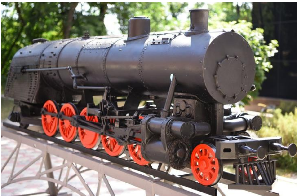
Модель паровозу з колісною формулою 1-5-0, виконана в ХММІ під керівництвом Петра Мухачова. Фото автора
