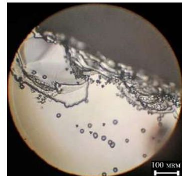
Рис. 3 – Порушення підкладки після скрайбування
