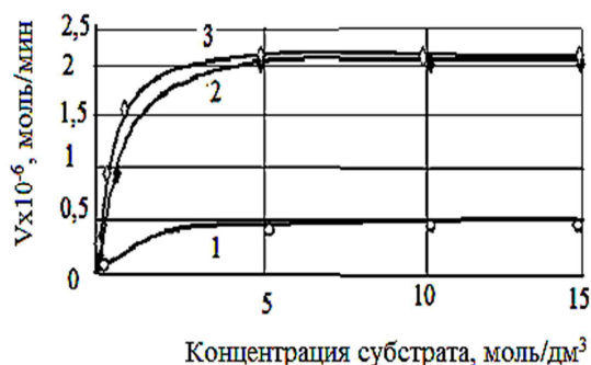
Рис. 6 – Зависимость скорости реакции деэтерификации яблочного пектина под действием пектинметилэстеразы ферментного препарата люцерны от начальной степени этерификации: 1- начальная степень этерификации пектина 80 %; 2 - начальная степень этерификации пектина 68 %; 3 - начальная степень этерификации пектина 40 %.
