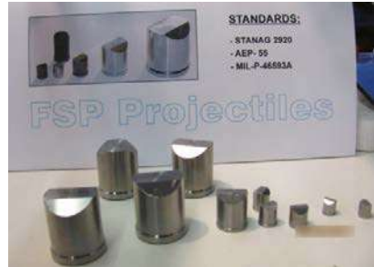
Рисунок 3б. Загальний вигляд боєприпасів, що використовуються при випробуваннях (а) та стандартні осколки (б)
