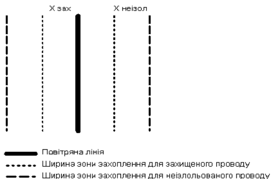
Рисунок 4. Експериментальні значення ширини зони захоплення блискавки для різних типів проводів
