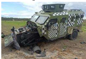
Рисунок 32. СБА «Варта» при натурній оцінці протимінної стійкості: а – зразок на місці випробувань; б – кадри підриву; в – результати підриву
