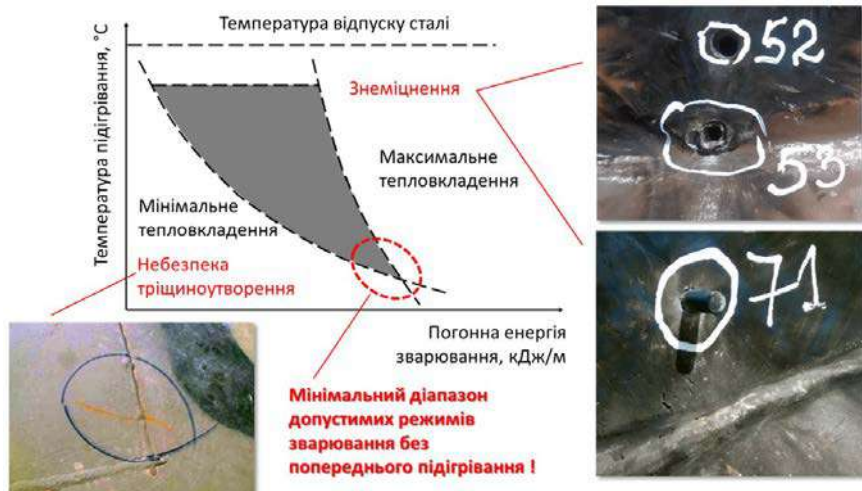
Рисунок 11. Діаграма температурного режиму зварювання загартованих низьковідпущених сталей [19]
