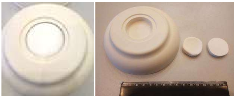
Рисунок 3. Зовнішній вигляд гіпсової форми при литті та вироб-сирець
