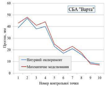
Рисунок 33. Прогини в місцях розташування ніг екіпажу та десанту СБА «Варта»:
