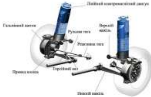
Рисунок 33. Підвіска коліс з пружним елементом і електричним лінійним двигуном
