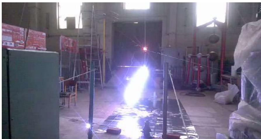
Рисунок 1. Фотографія ураження неізолюваного проводу на великогабаритній моделі під час першої серії експериментів.
