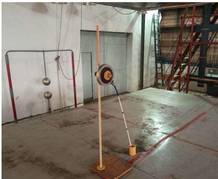
Рисунок 18. Датчик магнітного поля встановлений у центральну точку робочого об'єму NL254-H-2
