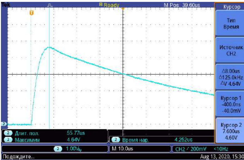
Рисунок 31. Час досягнення максимуму амплітуди T_{\text{макс}} = 8 \text{ мкс} , тривалість напівспаду T_{\text{имп}} = 60 \text{ мкс}
