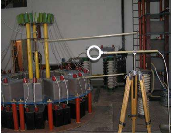
Рисунок 12. Зовнішній вид випробувального комплексу з встановленим датчиком ИНМП-2С, який розташований в точці h_{1,5\text{м}}
