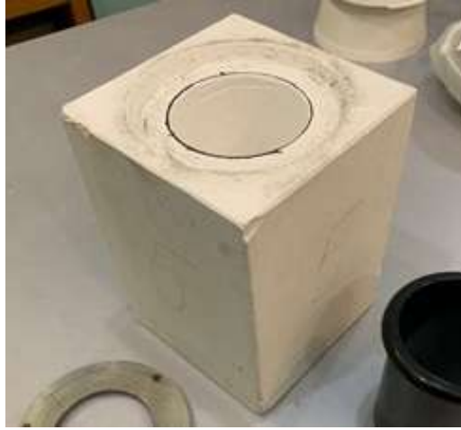
Рисунок 5. Гіпсова форма для формування обтічника та її складові
