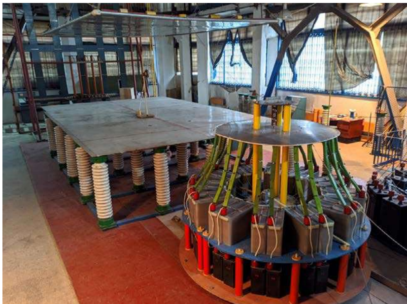
Рисунок 17. Зовнішній вид випробувального стенду NL254-H-2 1 – генератор імпульсних струмів; 2 – полеутворююча система з двох пластин; 3 – датчик магнітного поля ИНМП-1
