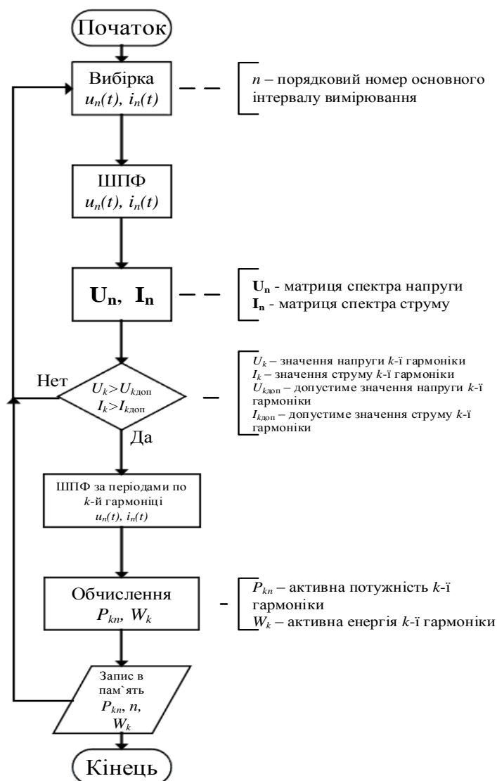
Рисунок 9 – Блок-схема алгоритму аналізу сигналів струму і напруги лічильником
