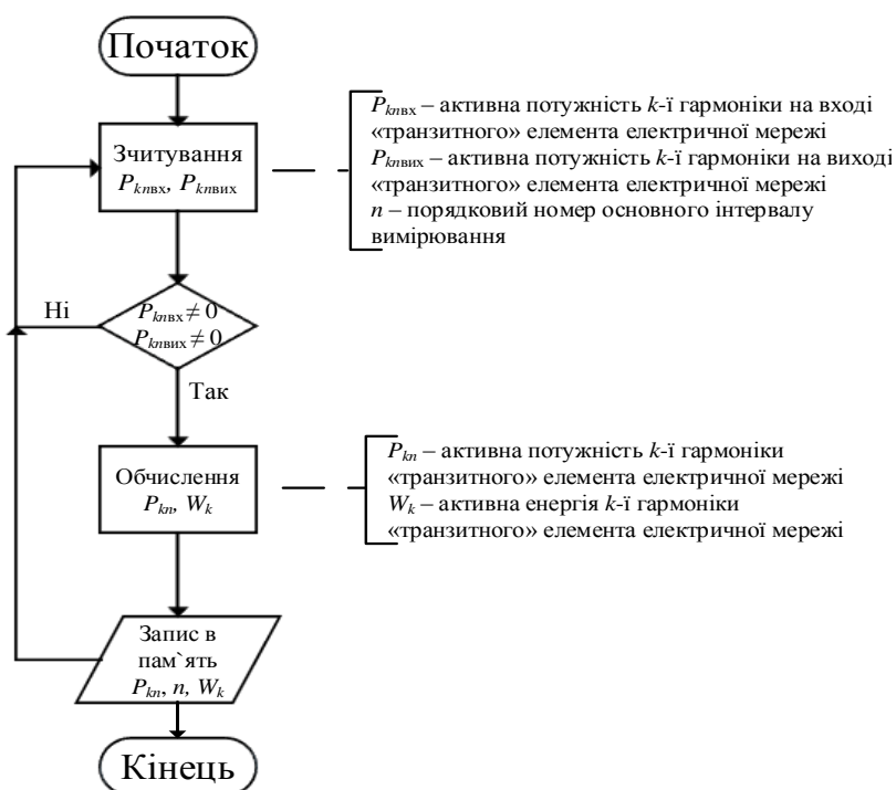
Рисунок 10 – Блок-схема алгоритму обчислення потужності вищих гармонік для «транзитних» елементів електричної мережі
