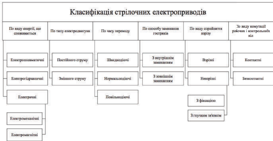
Рисунок 1.1 – Класифікація стрілочних приводів
