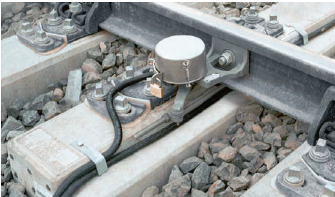
Рисунок 1.25 – Стрілочний детектор Paulvé на високошвидкісній лінії
