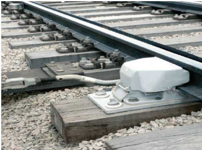
Рисунок 1.23 – Зовнішній замикач VCC, Франція
