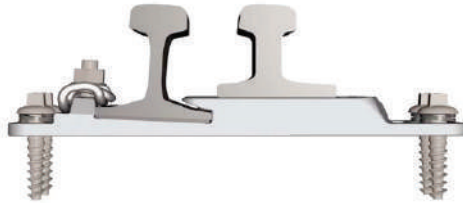
Рисунок 1.19 – Гостряк із нахилом, вигляд у поперечному перетині
