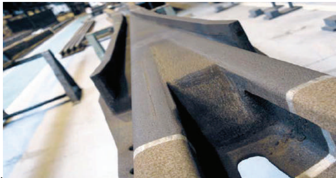
Рисунок 1.21 – Суцільноліта марганцева хрестовина з привареними рейковими закінченнями
