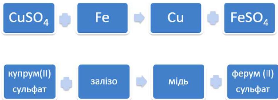
Рис. 14. Хімізм реакції заміщення
