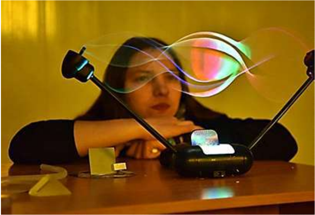
Рис. 8. Стояча хвиля: демонстрація за допомогою коливань закріпленого шнура
