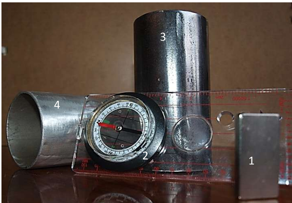
Рис. 6. Обладнання для демонстрації магнітного екранування
