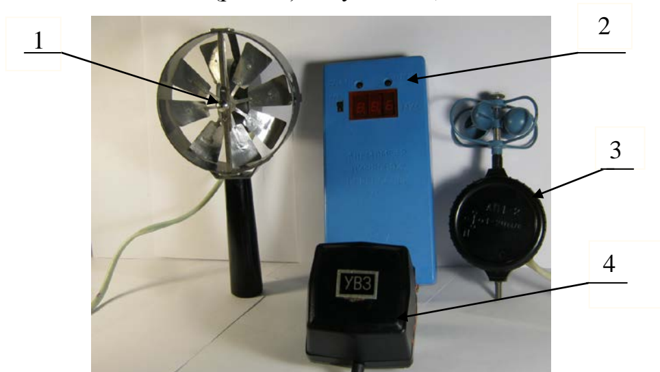
Рис. 7. Анемометр цифровий АП-1, де 1 – крильчастий датчик АП 1-1; 2 – цифровий вимірювальний перетворювач ; 3 – чашковий датчик АП 1-2; 4 – блок живлення.
