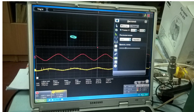
Рисунок 3.16 – Осцилограми напруженості електричного поля (червона крива) та вектора поляризації (жовта крива) конденсатора з полярним діелектриком.
