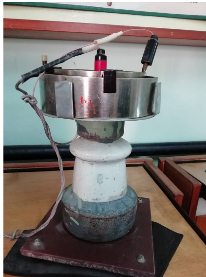
Рисунок 2.6 – Загальний вигляд вимірювальної комірки з досліджуваним рідким діелектриком та системою циліндричних електродів діаметрами d_1 , d_2 для вимірювання електричної ємності та тангенсу кута діелектричних втрат у діапазоні частоти 100 Гц – 100 кГц
