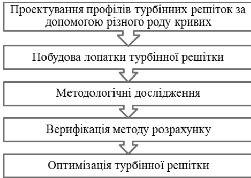
Рисунок 1 – Блок-схема методики оптимізації турбінної решітки
