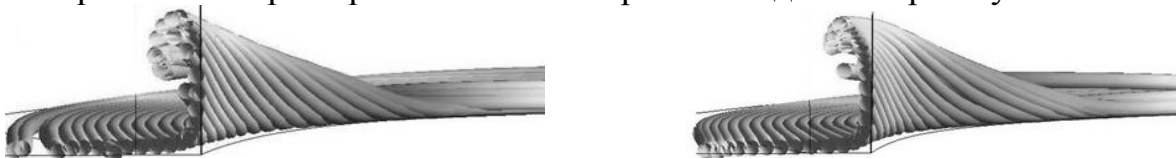
Рисунок 12 – Лінії току в приторцевій області міжлопаткового каналу
