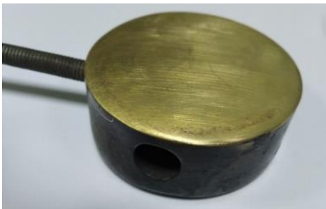
Рисунок 2.2 – Латунний диск для визначення температурних інтервалів плавлення і деструкції полімерів
