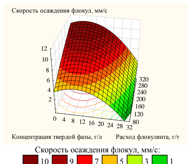
Рис. 1 Зависимость скорости осаждения флокул от концентрации твердой фазы и расхода флокулянта
