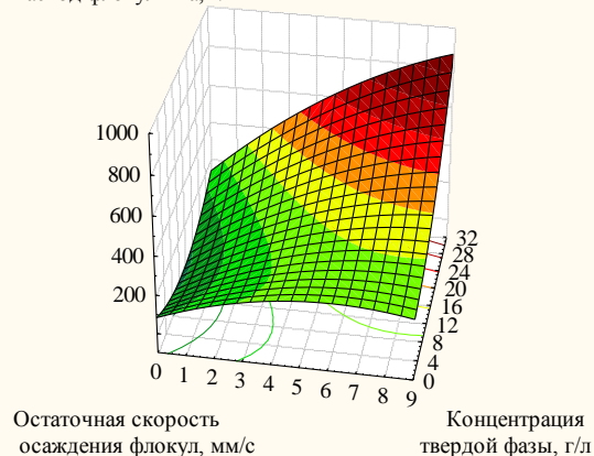
Рис. 4. Зависимость скорости осаждения флокул после гидромеханического воздействия в течение 40 с при скорости движения шлама до 2 м/с от концентрации твердой фазы и расхода флокулянта
