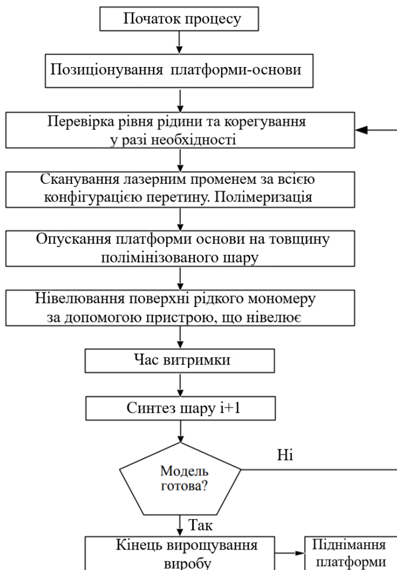
Рисунок 4.26 – Алгоритм процесу лазерної стереолітографії
