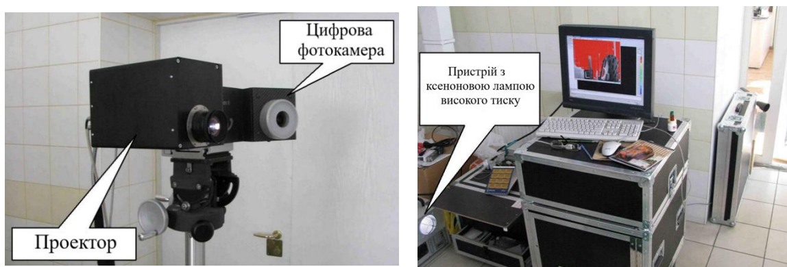
Рисунок 2.8 – Оптико-цифрова установка об'ємного сканування Imetric IScan II
