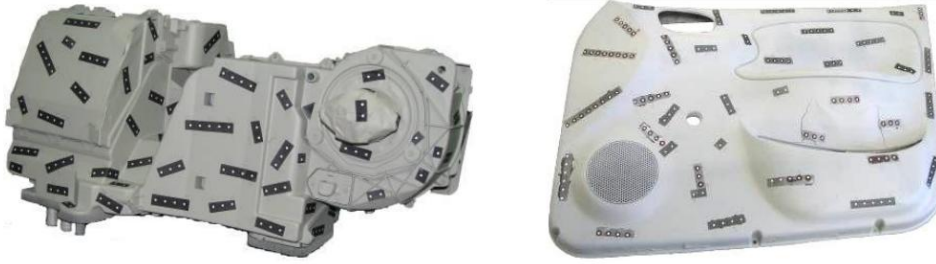
Рисунок 2.10 – Об'єкти (опалювальна піч та обшивка передніх дверей автомобіля) підготовлені для сканування на оптико-цифровій установці
