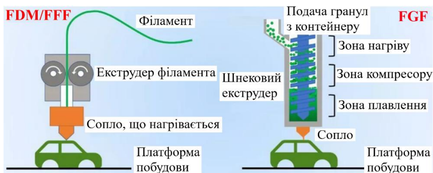
Рисунок 4.15 – Порівняльна схема методів FDM/FFF і методу FGF
