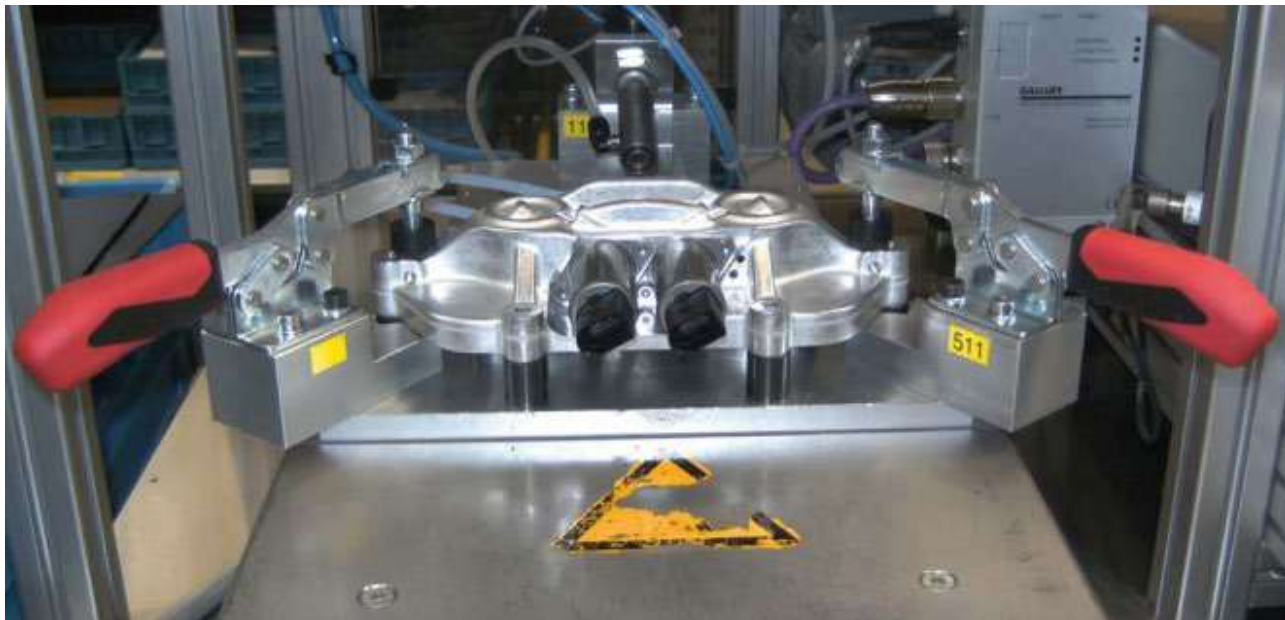
Рисунок 7.13 – Приклад уніфікованого затискного пристрою компанії AMF
