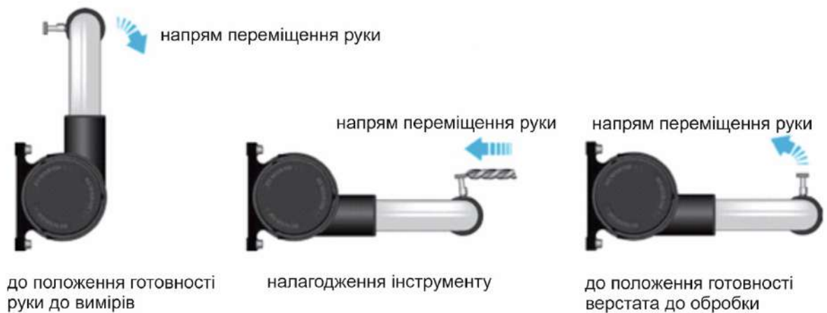
Рисунок 7.50 – Послідовність налаштування інструменту з використанням руки компанії RENISHAW
