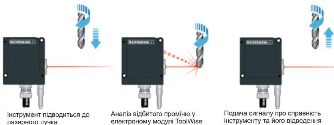
Рисунок 7.60 – Послідовність роботи системи виявлення несправного інструмента
