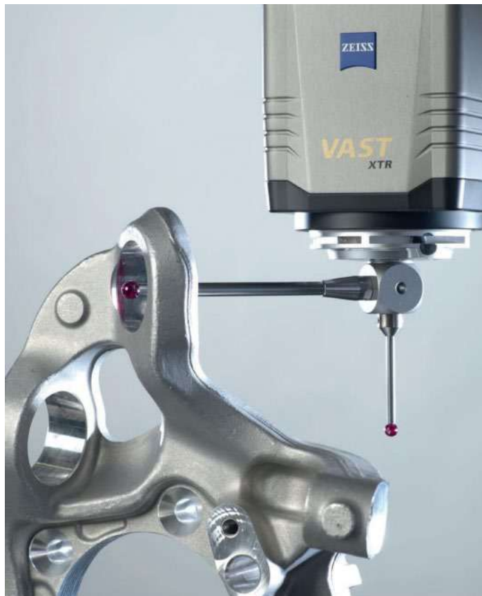
Рисунок 5.27 – Приклад роботи координатно-вимірювальної машини
