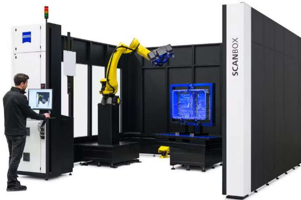
Рисунок 5.30 – КВМ на основі робота «вільна рука»
