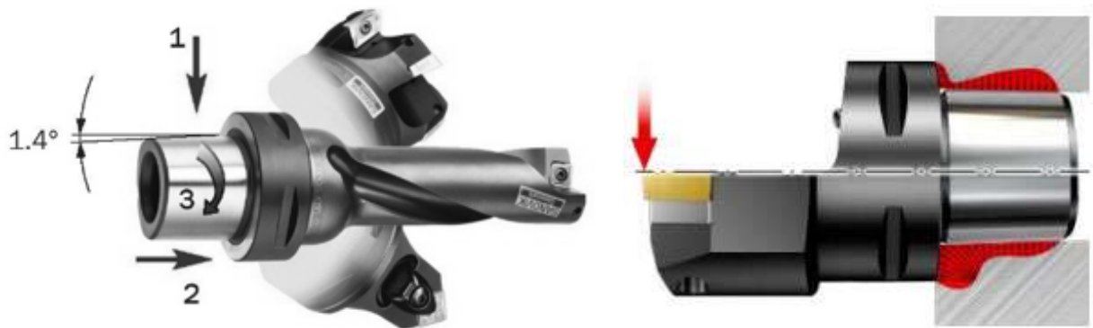
Рисунок 4.17 – Схема рівномірного розподілу навантаження у Coromant Capto На рисунку 4.18 показано схему закріплення інструментальної оправки Coromant Capto у шпинделі верстата або на револьверній головці.
