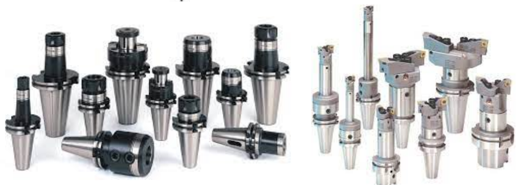
Рисунок 4.20 – Комплект допоміжного та різального інструменту до багатоопераційного верстата
