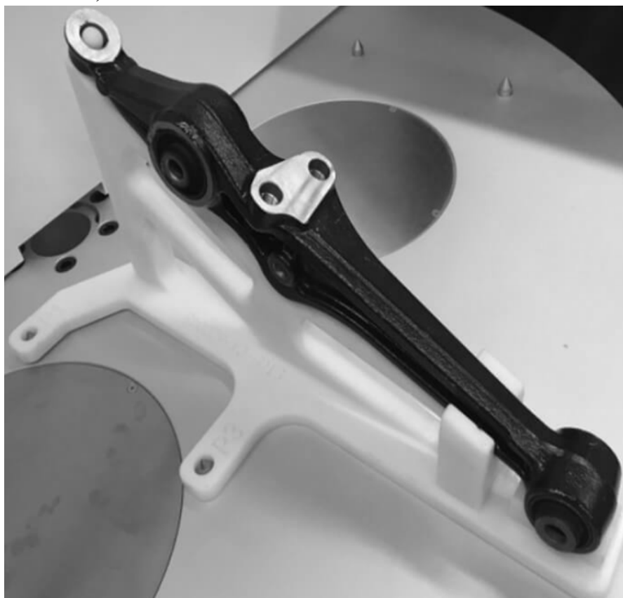
Рисунок 7.4 – Приклад пристрою, виготовленого на 3D принтері
