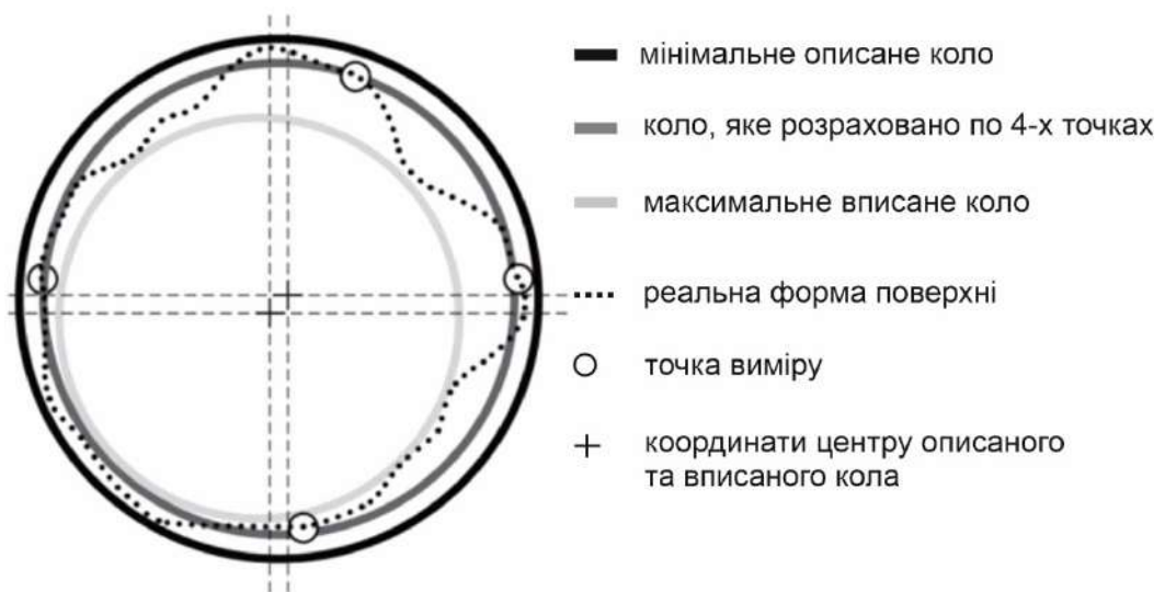
Рисунок 5.36 – Контроль геометричних характеристик отвору
