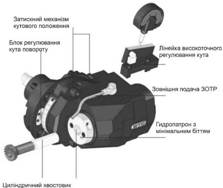
Рисунок 7.31 – Конструкція зубодовбального модуля фірми WTO
