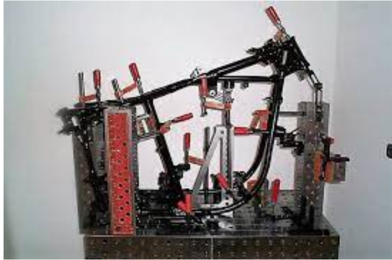
Рисунок 6.2 – Приклад пристроїв для збирання та зварювання рами велосипеда
