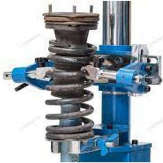
Рисунок 6.3 – Пристрій для попереднього стиснення пружини амортизатора
