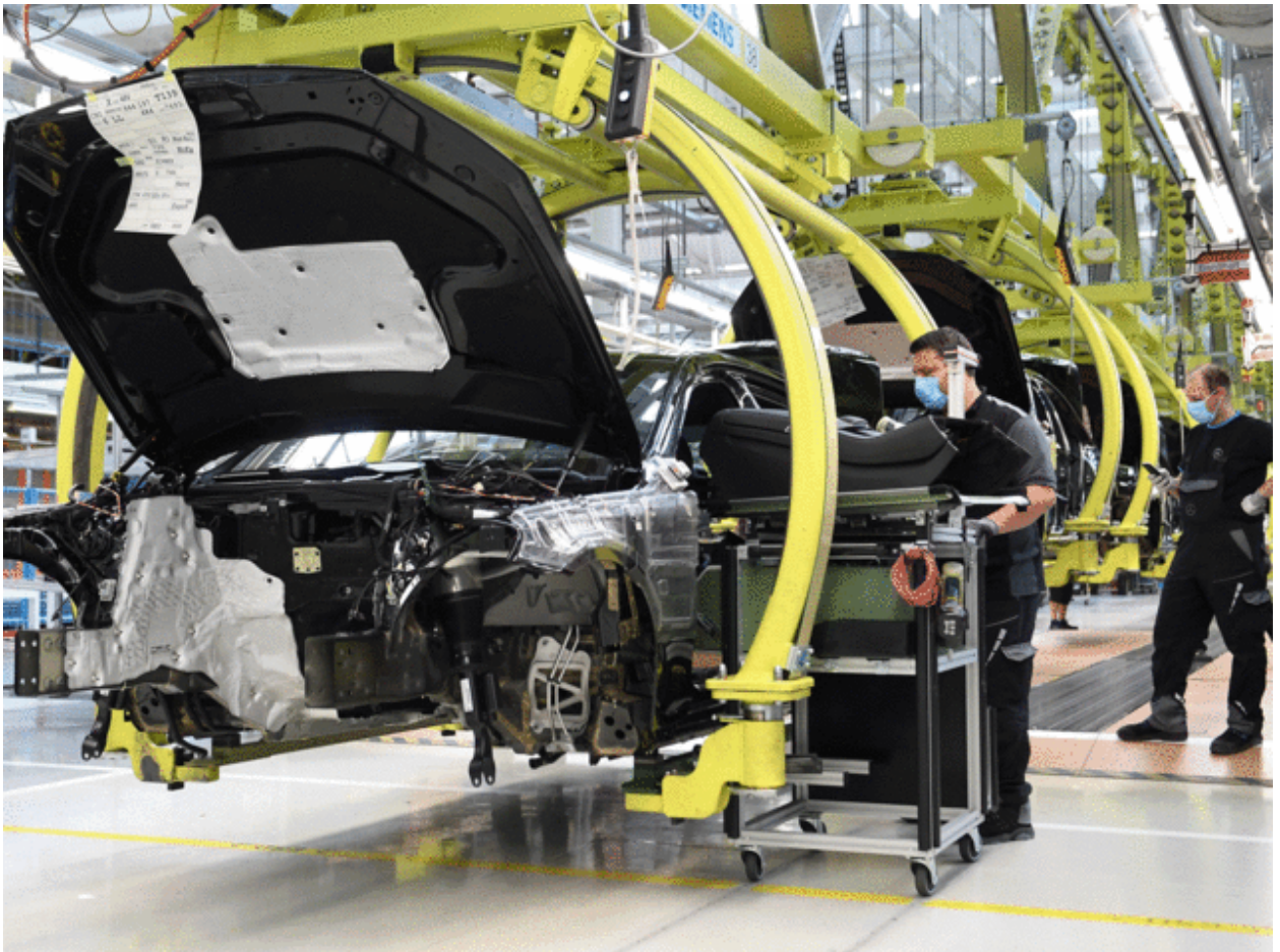
Рисунок 6.1 – Приклад нерозбірного складального пристрою з елементами транспортно-завантажувальної системи
