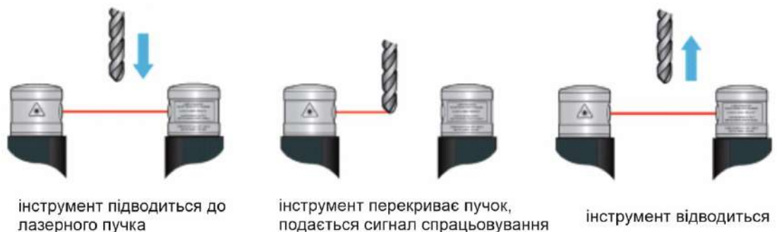
Рисунок 7.51 – Послідовність роботи лазерної системи налагодження інструменту
