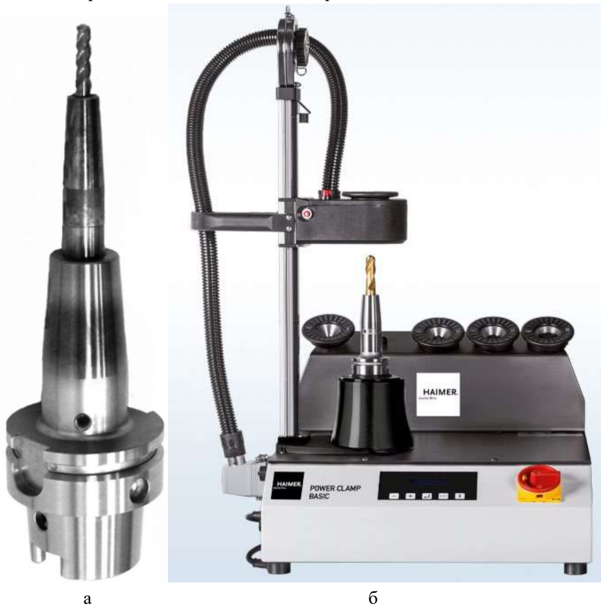
Рисунок 7.41 – Інструмент у термооправці та термозатискна машина фірми HAIMER
