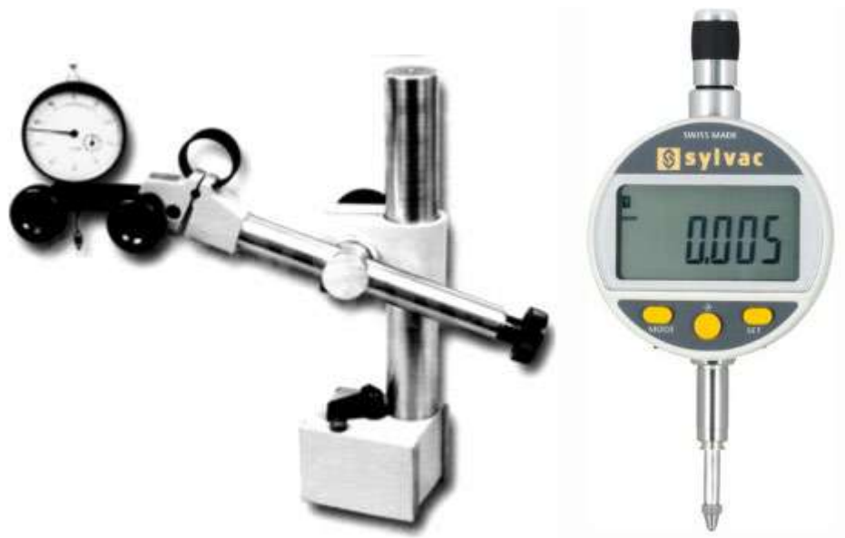
Рисунок 5.7 – Індикатори: а –годинного типу на стандартній магнітній стійці; б – електронний цифровий
