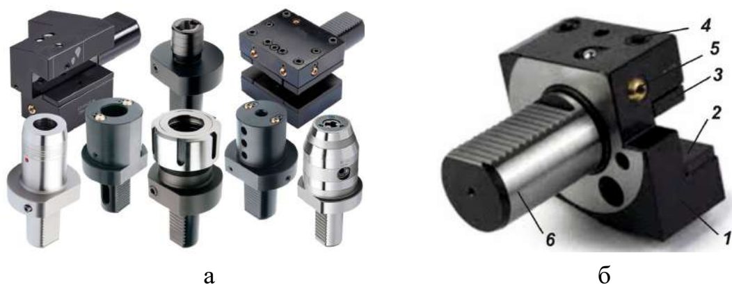
Рисунок 4.27 – Конструкція тримачів із циліндричним хвостовиком VDI для різних інструментів
