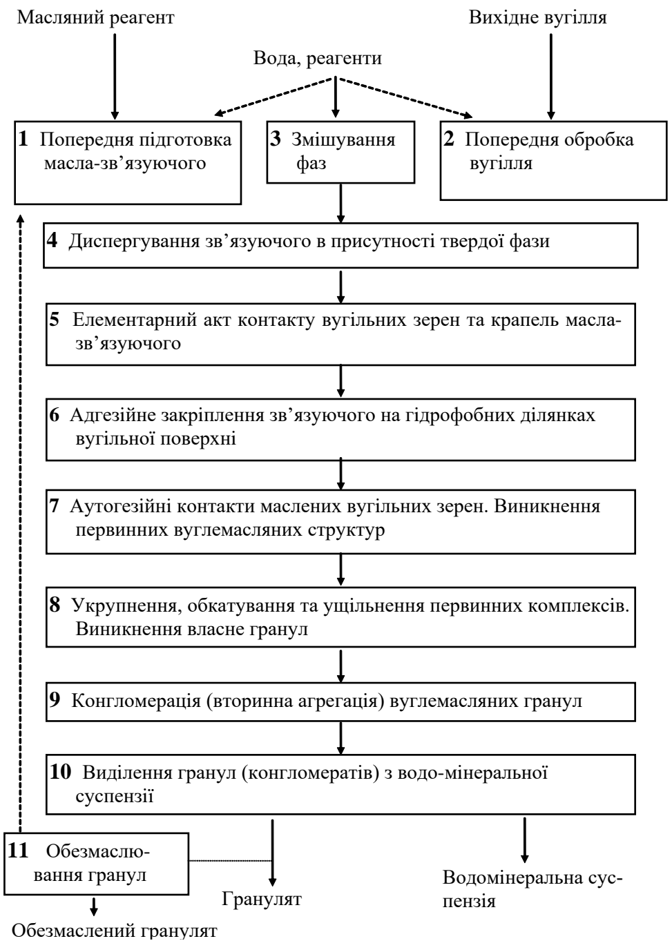
Рис.1.3 Феноменологічна модель процесу масляної грануляції по “коалесцентному” механізмі
