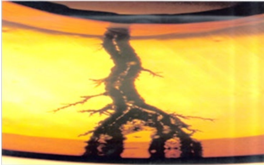
Рисунок 1.7 – Характерний слід електротеплового пробою системи ізоляції сучасного високовольного ЗПЕ-кабелю: вплив температури діелектрика на напругу пробою і тривалість розвитку пробою є свідченням перетворення енергії електричного поля на теплову (розсіяння енергії електричного поля)
