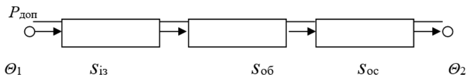
Рисунок 1.2 – Схема заміщення теплового потоку одножильного кабелю типу АПВГ у стаціонарному тепловому режимі:
