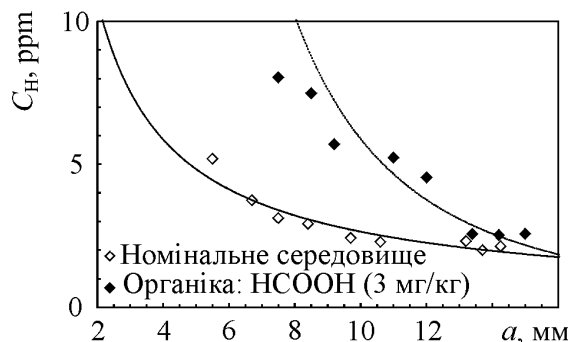
Рис. 8 – Залежність локальної концентрації водню біля вершини втомної тріщини (на віддалі 0,1 мм від її вершини) від її довжини в сталі 16ГС за випробувань у середовищі номінального складу та з органічними домішками
