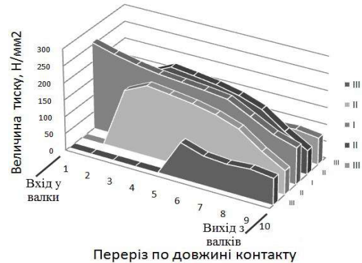
Рис. 9 – Розподіл величини K_{зН} по перерізам при прокатуванні в круглому калібрі кліті №16
