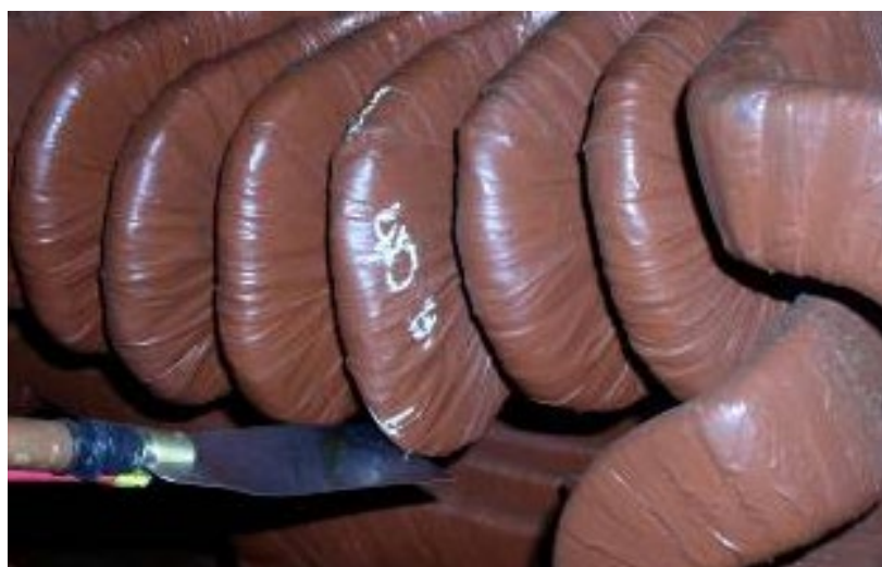
Рисунок 3.2 – Дефект, що обумовлено недостатньо якісним процесом ізолювання і просочення електроізоляційної системи [78]
