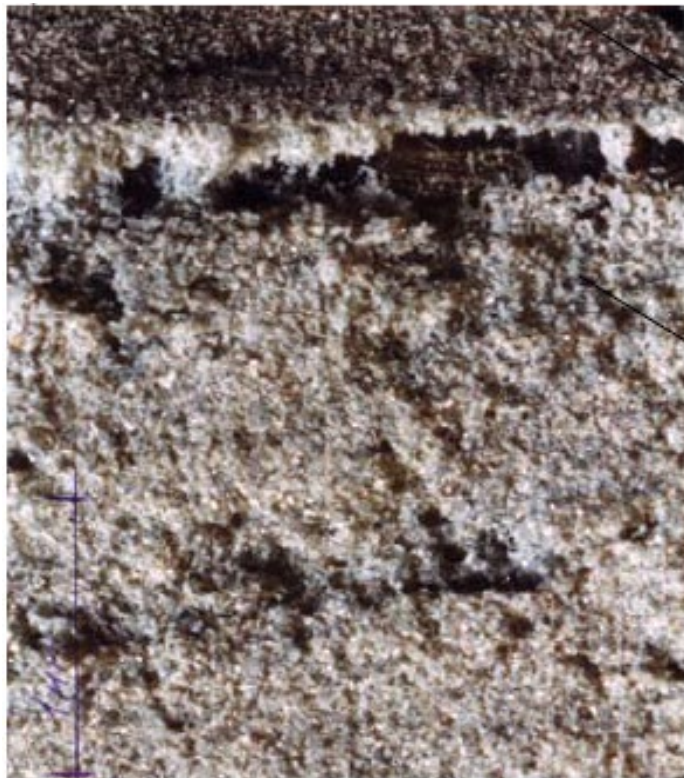
Рисунок 1.9 – Фотографія протикоронного покриття пазової (верхня частина) та лобової (нижня) частин після 1080 годин теплового старіння [46]
