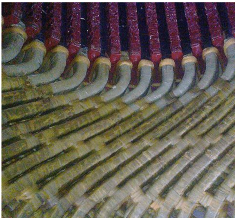
Рисунок 1.4 – Загальний вигляд термореактивної ізоляції «Моноліт-4» після запікання
