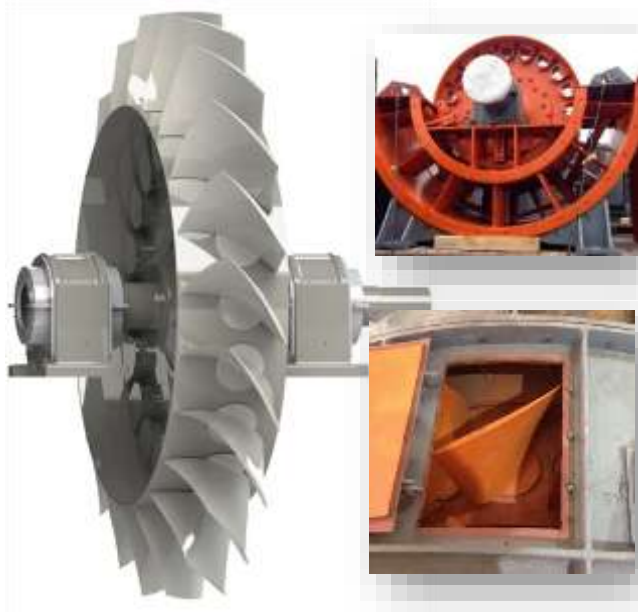
Рисунок 25 – Ротор вентилятора головного провітрювання рудника ВО-32 з електродвигуном потужністю 4.5 МВт
