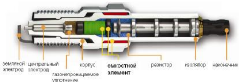
Рис. 4. Схема устройства свечи зажигания Pulse Plug [8]
