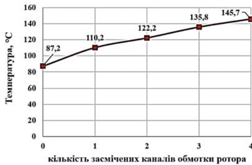
Рис. 5. Максимальна температура в пазу ротора в залежності від кількості засмічених каналів ОР
