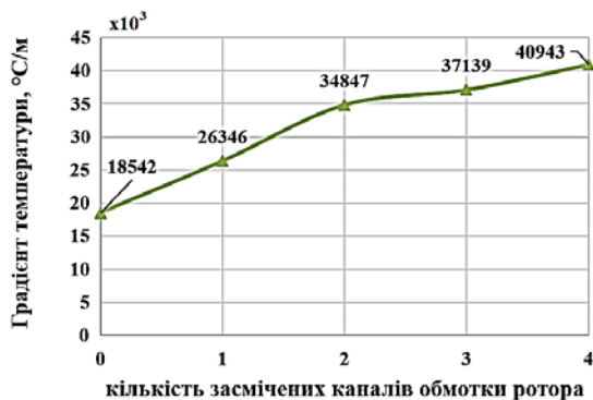
Рис. 6. Максимальні значення градієнта температури в склотекстолітовій ізоляції в залежності від кількості засмічених каналів ОР
