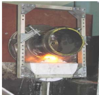
Рис. 7.23. Навісний пристрій для зміцнювальної обробки циліндричних деталей
