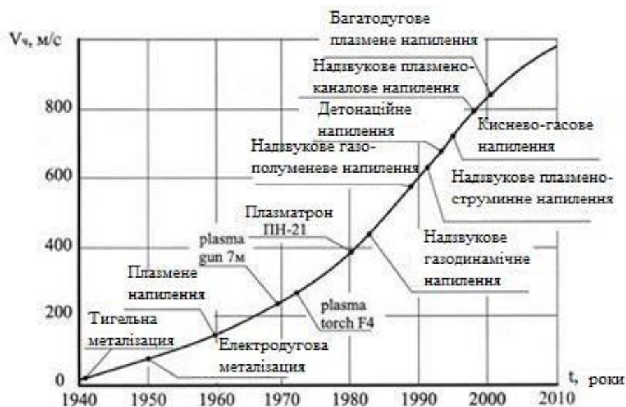
Рис. 7.12. Хронологічна залежність швидкості частинок порошку для деяких способів газотермічного напилення
