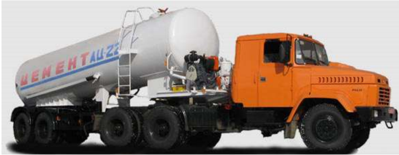
Рис. 14.6. Автоцементовоз на КрАЗ
