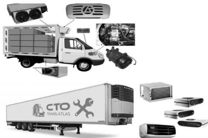
Рис. 3.6. Холодильно-силові установки рефрижератора
