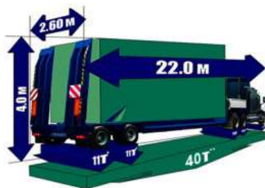
Рис 8.4. Максимально допустимі габаритні та вагові параметри, при яких дозволено рух без виконання вимог спеціальних правил
