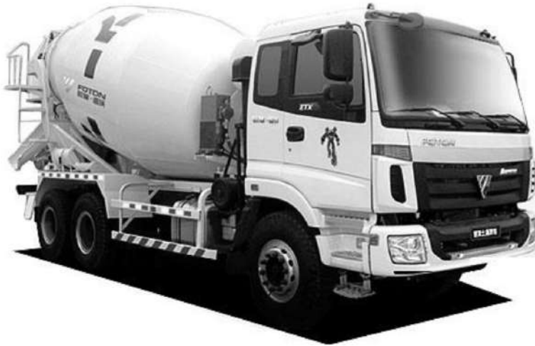
Рисунок 17.3 — Автобетонозмішувач Foton Auman ABC-9–3258
