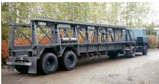
Рис. 10.5. Напівпричепи-панелевози: а – хребтовий; б – касетний
