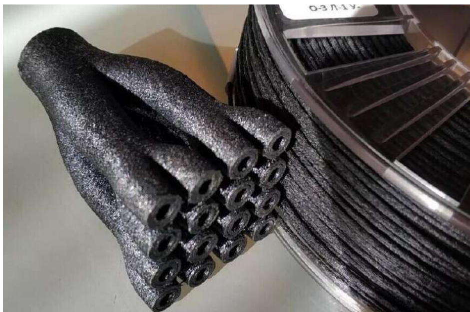
Рисунок 3 – Склонаповнений композит TERMAX GF-40 компанії Filamentarno
