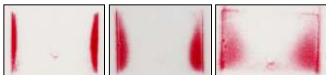
Рис. 29. Приклади контактних відбитків при зменшенні жорсткості пружного шару в 2 і 4 рази (від базової зліва направо)
