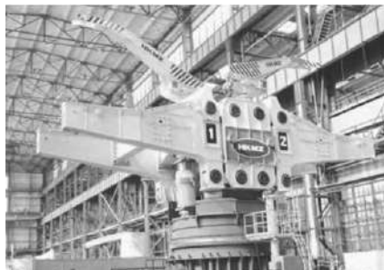
Рис. 6. НКМЗ спочатку існування створював великі машини. Від вугільних млинів у першій половині ХХ століття до сталерозливних стелів МБЛЗ, вантажопідйомність – 760 т (двох ковшів) у першій половині ХХІ століття
