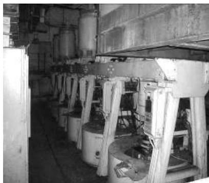
Рис. 4. Сучасне цукроварне обладнання – центрифуги першого (ліворуч) і третього (праворуч) продуктів. Встановлені в 1980-х рр. на Андрушівському цукровому заводі, м. Андрушівка Житомирської обл. Фото 2000-х рр., сьогодні завод не працює
