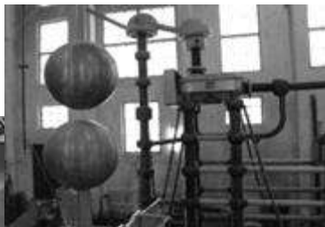
Рис. 14. Високовольтна зала НТУ «ХПІ» з каскадом трансформаторів напругою 1 млн вольт та комплекс з генераторами імпульсних напруг 1,2 і 4 млн вольт
