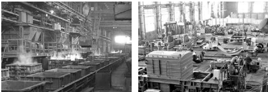
Рис. 7. Від ділянки для виробництва виливків тубінгів на ДЗМО до збирання металургійного штовхача ТШ-16-40 для пересування вагонів біля доменної печі (на передньому плані) в цеху «Дніпроважмаш».
