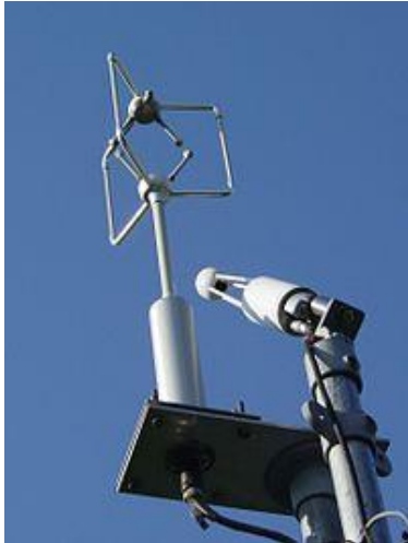
Рис.1 - Система вихрової коваріації, що складається з ультразвукового анемометра та інфрачервоного газоаналізатора
