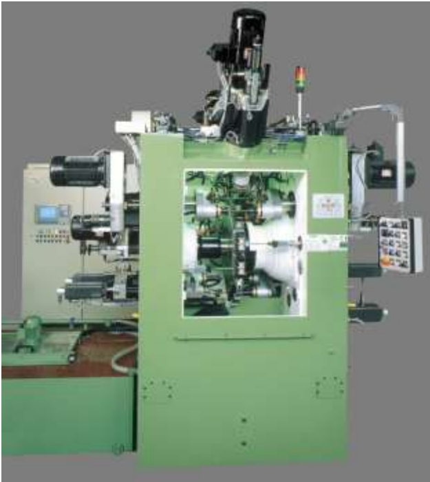
Рис. 3 – Компонка агрегатного станка с поворотным-делительным барабаном Picchi TR 6-9/OSE
